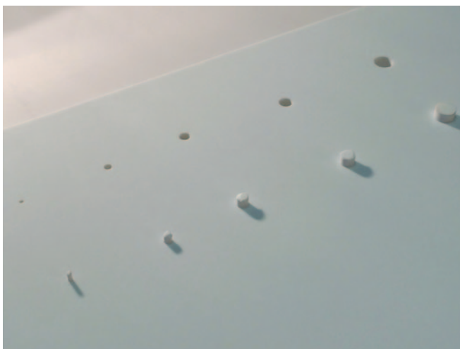
Ilustracja 5. Płyta z wprowadzonymi korkami
