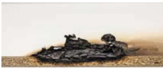
Przekrój płyty Eurodekor Flammex po 30 minutach działania płomienia
