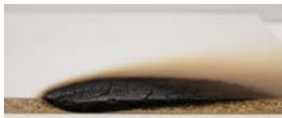
Przekrój płyty Eurodekor po 30 minutach działania płomienia
