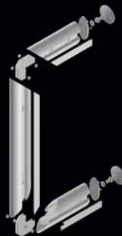
Element konstrukcyjny ściana-ściana
