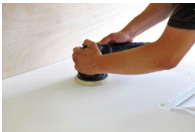
Do wykańczania powierzchni stosować szlifierkę orbitalną
